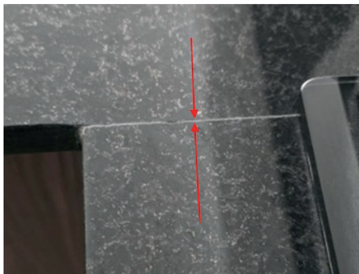
Fig. N° 59: Espesor de juntas
